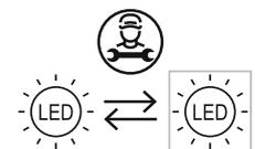
Das in diesem Gerät enthaltene Leuchtmittel darf nur durch qualifiziertes Personal und unter Verwendung von Original-Ersatzteilen ausgetauscht werden.
